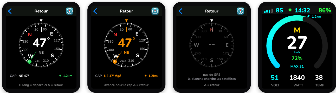
En route cap NE 47°, départ à 1,2 km (pastille verte) À l'arrêt cap figé en orange : avance pour l'actualiser
